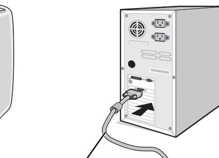
Signalkabel mit 15-poligem Mini-D-SUB-Stecker
