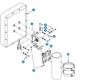
Befestigen Sie dann wie abgebildet die Montageplatte 4 mit den beiliegenden Mastschellen 10 an einem ausreichend tragfähigen Mast.
