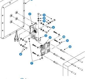
die Montageplatte 4 mit geeigneten Schrauben (10) \*, Unterlegscheiben (11) \* und ggf. Dübeln (12) \* (abhängig vom Wandmaterial) an einer ausreichend tragfähigen Wand.
